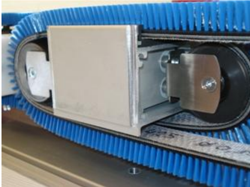
Pneumatische Spannrolle sorgt für gleichmäßige Spannung der Tresy-Linearbürste
