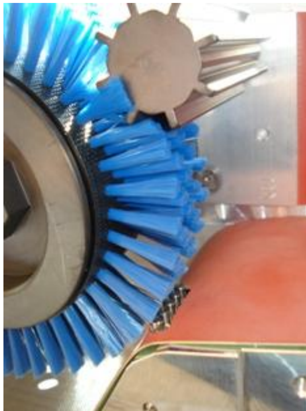
Verbesserte Selbstreinigung der Tresy-Linearbürste
